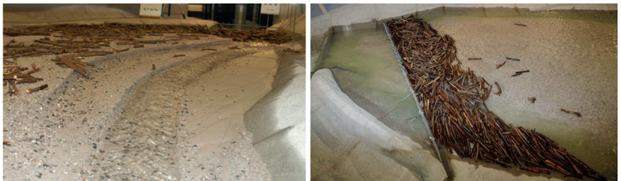
Abbildung 7: Linkes Bild: Geschiebeausstrag beim abklingenden Hochwasser ohne See, rechtes Bild Situation bei Seebildung.
