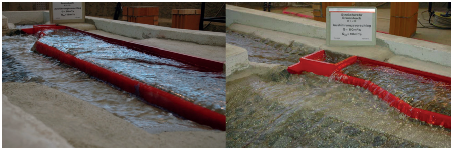
Abbildung 2: Ausführungsvorschlag des Streichwehres und Regulierorganes bei maximalem Zufluss
