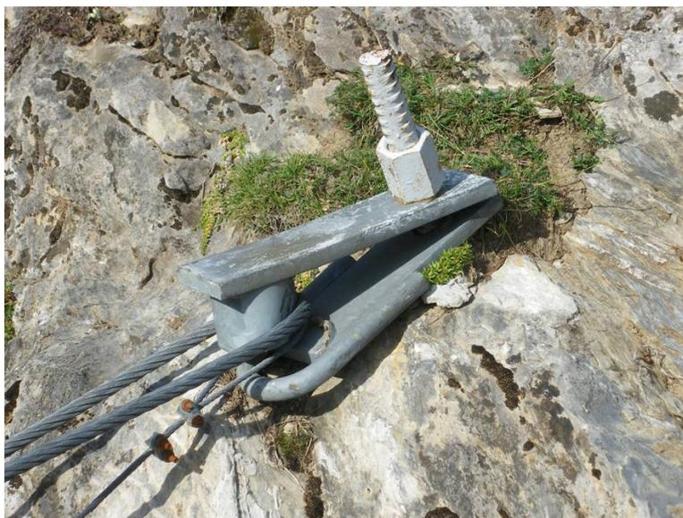
**Fig. 3** Pièce d'ancrage défectueuse
