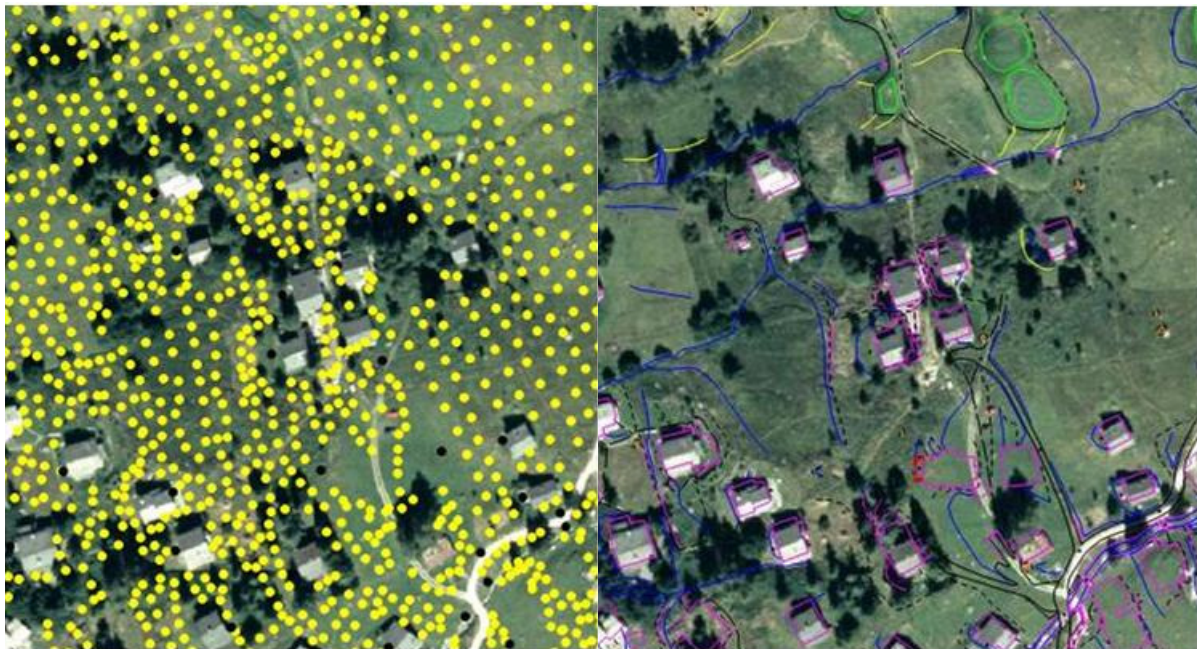
Fig. 2 Relevé photogrammétrique : à gauche les points, à droite les lignes de rupture.
