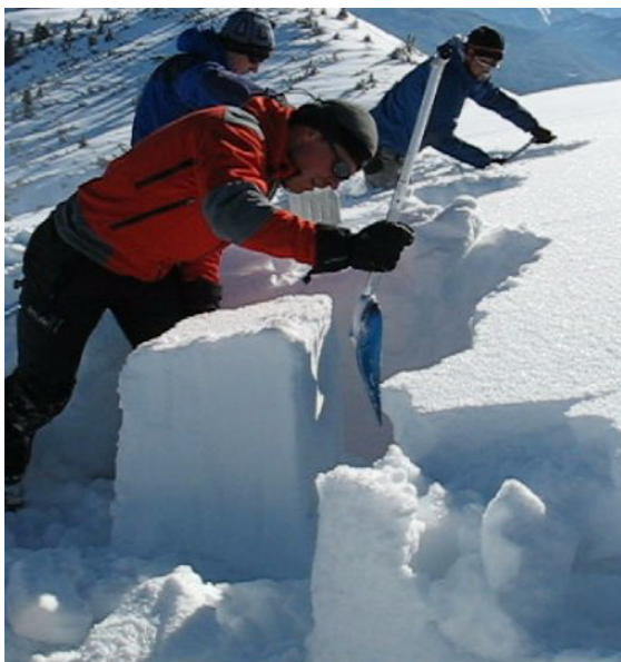
Abb. 1 Kleiner Blocktest: Suche nach Schwachschichten durch seitliches Klopfen
