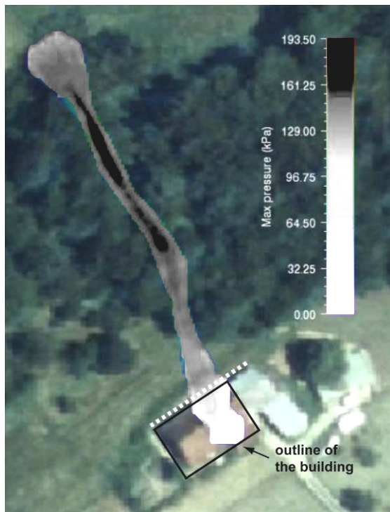
Fig. 10 Debris flow simulation (Köniz / standard Voellmy)
