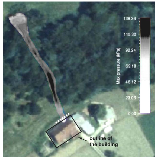
Fig. 11 Debris flow simulation (Köniz / extended Voellmy)
