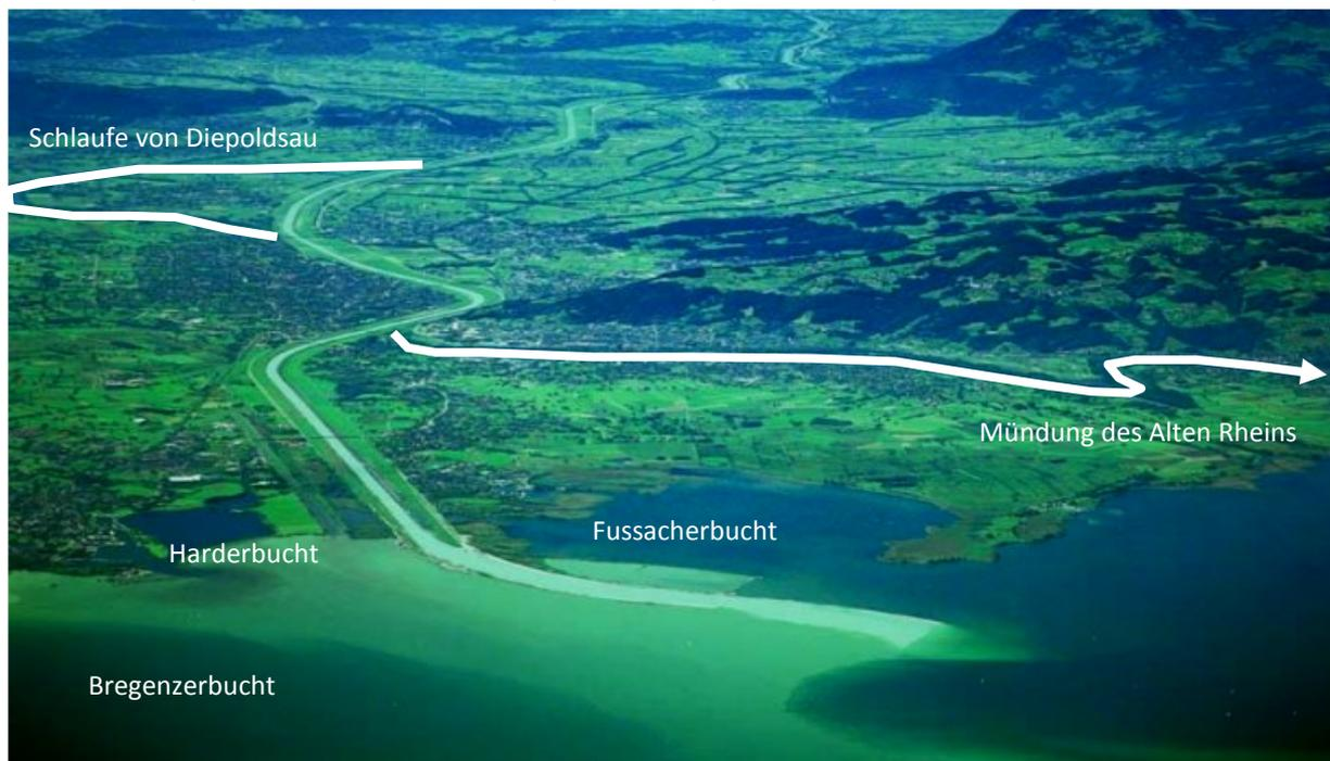
**Fig. 1** Unterer Bereich des regulierten Alpenrheins mit Blick gegen die Fließrichtung. Die Schlaufe von Diepoldsau wurde abgeschnitten und die Mündung nach Fussach verlegt.
