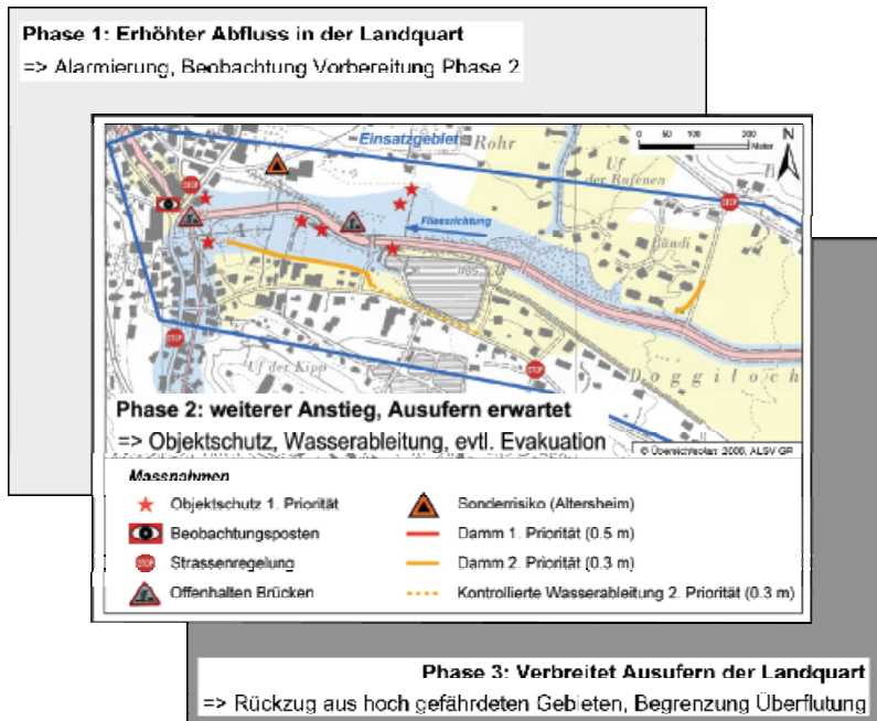
Abb. 5: Ausschnitt aus der Interventionskarte Landquart, Klosters (Schweiz) Fig. 5: Detail of the intervention plan Landquart River, Klosters (Switzerland)
