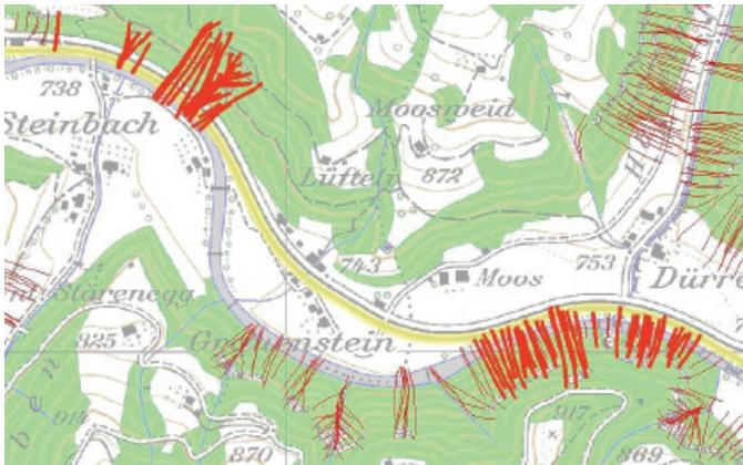
**Abb. 4:** Steinschlagtrajektorien (rot) und Schadenpotenzial (Eisenbahn, gelb dargestellt) sowie schadenpotenzialrelevante Steinschlagtrajektorien (fett rot)
