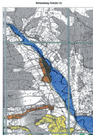
Abb. 2: Planungsperiode 1, Bauland sowie HQ 30 und HQ 100 ausgewiesen
