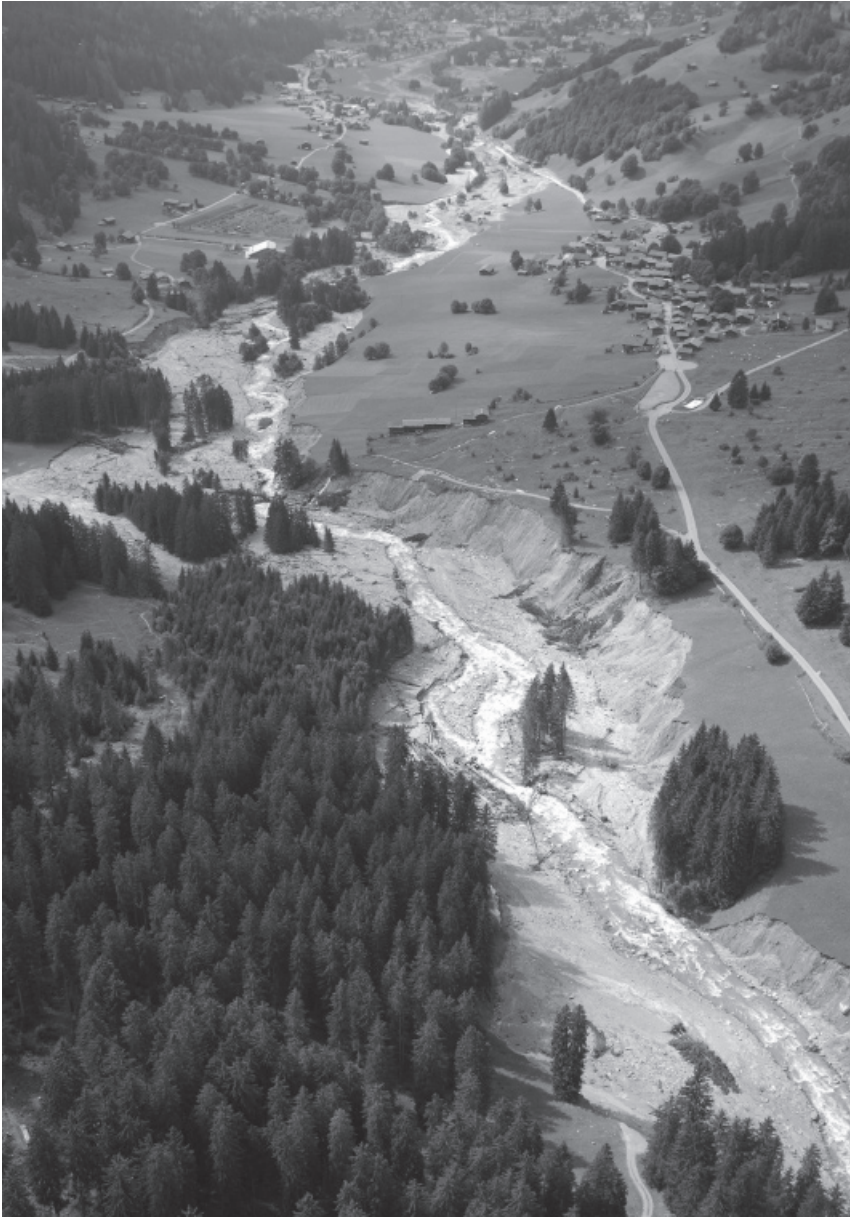
Abb. 5: Gerinneverlagerungen der Landquart oberhalb von Klosters GR (Foto: Schweizer Luftwaffe) Fig. 5: channel erosion in the Landquart river upstream of Klosters GR (photo: Swiss Air Force)
