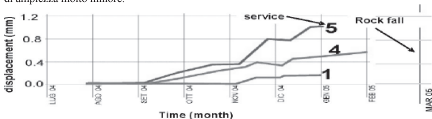
Fig. 9: Curva tempo - spostamento di 3 estensimetri installati sul Mammellone 1
