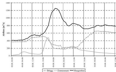
**Abb. 7:** Während Hochwasser wird der Ausfluss des Bielersees bei Brügg kurzfristig entsprechend dem Zufluss der Emme bei Emmenmatt gedrosselt.
