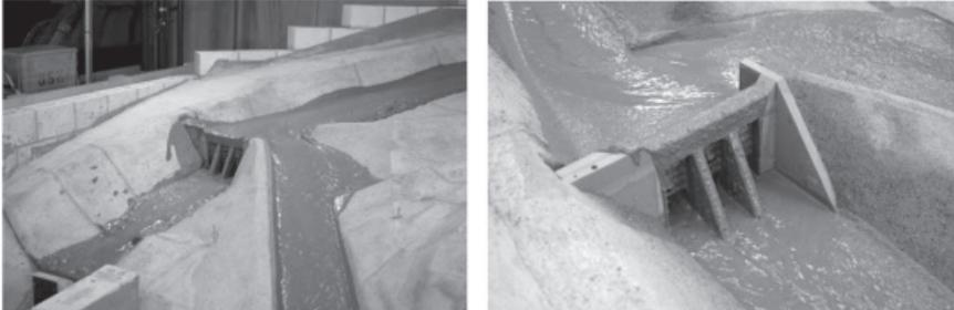
**Abb. 6:** Verhalten des Ausleitbauwerkes bei einem Grossmurgang. Der Murgang wird grösstenteils ausgeleitet.
