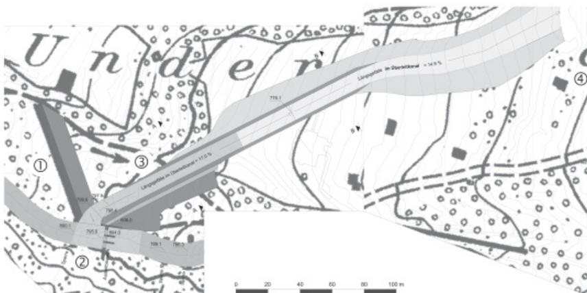
**Abb. 11:** Situation von Ausleitbauwerk und Überleitkanal: ① bestehendes Seitenleitwerk, ② Ausleitbauwerk, ③ Überleitkanal, ④ Ablagerungsraum.
