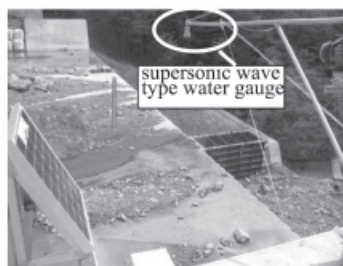
Abb.4: Der Überschall Wellenart Wassermaßstab für den Überlaufenteil des Oshima Scheckdammes
