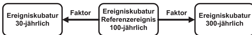
Abb6: Herleitung der Feststofflieferung von 30- und 300-jährlichen Ereignissen basierend auf 100-jährlichen Referenzereignis und mittels Faktoren
