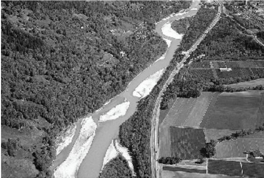
Oberhalb von Buchs wirken sie gegen die fortschreitende Eintiefung und im Abschnitt oberhalb des Bodensees, wo das Schadenpotenzial besonders hoch ist, kann die Abflusskapazität erhöht werden. Die Flussaufweitungen beeinflussen das Grundwasser positiv, erhöhen die morphologische und ökologische Vielfalt und schaffen wertvolle Erholungsräume für Bewohner und Gäste des Rheintals.
