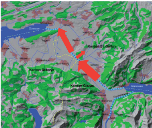
Abb. 13: Konzept Überlastfall beim Linthkanal: Ableiten der Mehrwassermenge oberhalb Flussabschnitt mit beidseits freistehenden Dämmen.
