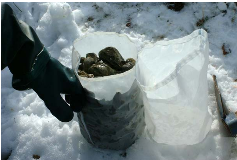
Foto 10: geschlammtes Substrat wird in Netzzylinder gefüllt
