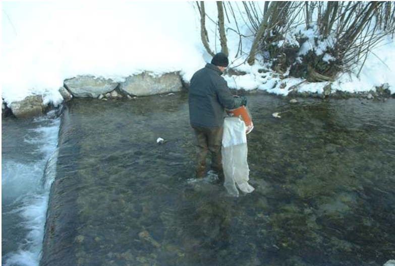
Foto 9: Ökologische Steinkastenschwelle (Untersuchungsstelle 7), Probeentnahme mit dem Heß-Sampler
