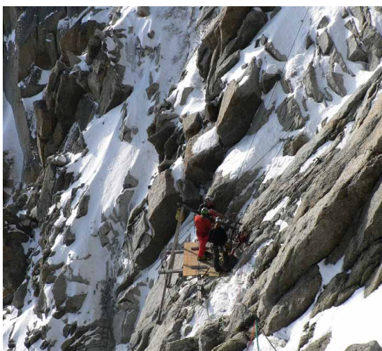
Perforazione in parete per l'installazione di sensori termometrici. Foto: P. Deline
