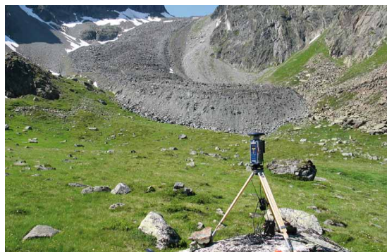
Fig. 7: Stazione di riferimento DGPS in un punto fisso d'osservazione di fronte al rock glacier Reichenkar (Austria). Foto: K. Krainer
