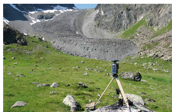
Fig. 7: Station de référence DGPS sur un point fixe face au glacier rocheux de Reichenkar (Autriche). Foto: K. Krainer
