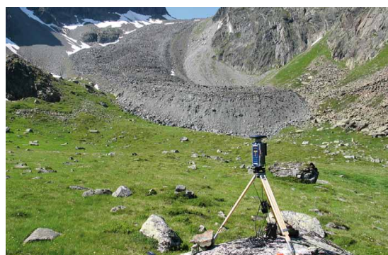
Abb. 7: DGPS Referenzstation auf einem Fixpunkt vor dem Reichenkar Blockgletscher (Österreich). Foto: K. Krainer
