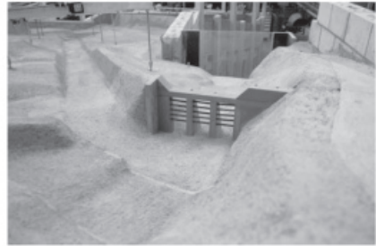
Abb. 9: Links: Vorschlag Projektteam. Rechts: optimierte Geometrie des Ausleitbauwerks. Fig. 9: Left: Proposal of the engineers. Right: optimized geometry of the diversion structure.
