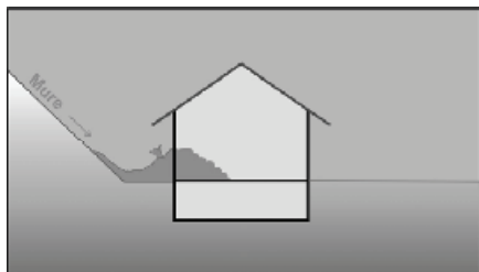
Abb. 5: Gefährdungsbilder durch Muren. Fig. 5: Damage patterns due to debris flows.
