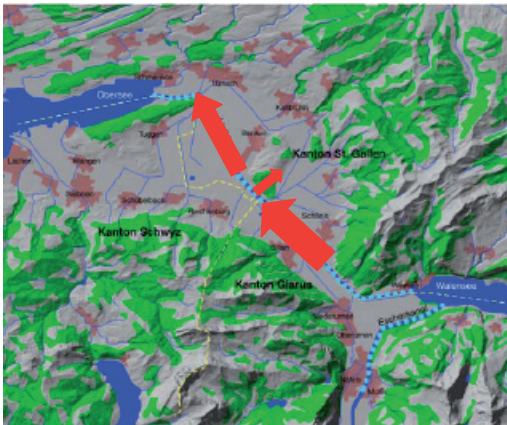
Abb. 13: Konzept Überlastfall beim Linthkanal: Ableiten der Mehrwassermenge oberhalb Flussabschnitt mit beidseits freistehenden Dämmen.
