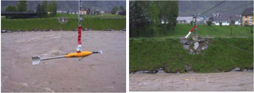
Abb. 7, 8: Abflussmessungen mit Seilkrananlagen bei Hochwasser: Linkes Bild: Flügel nicht eingetaucht, rechtes Bild: Flügel eingetaucht: grosse Auslenkung des Seils (siehe rot-weisser Sichtbalg), Folge: ungenaue Wassertiefenmessung.
