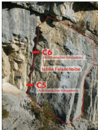
Abb. 2: Labile Felscheibe (rund 1'000 m 3 ) am Brünigpass über der Nationalstrasse N 8 (Kt. Bern, Schweiz) mit Lage der automatischen Weggeber C5 und C6
