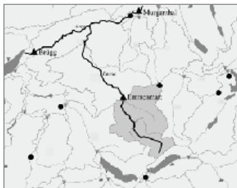
Abb. 4: Situationsplan für das Einzugsgebiet der Emme und den Zusammenfluss mit der Aare. Die Regenmesser sind als Punkte, die Abflussmessstationen als Dreiecke dargestellt.
