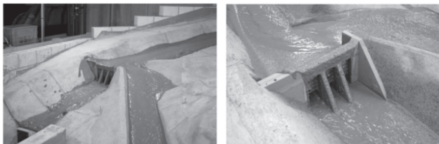
Abb. 6: Verhalten des Ausleitbauwerkes bei einem Grossmurgang. Der Murgang wird grösstenteils ausgeleitet. Fig. 6: Behaviour of the diversion structure during an extreme event. The main part of the debris flow is deviated.
