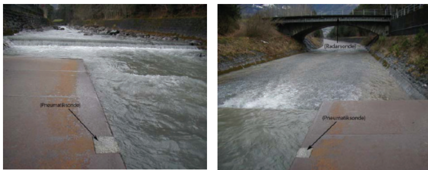
Abb. 1, 2: Abflussmessstation Schächen-Bürglen. Bild links: Blick gegen die Fliessrichtung mit Vorschwelle und Messgerinneeinbau (Pfeil: Profil Pneumatiksonde); Bild rechts: Blick in Fliessrichtung mit Messgerinneeinbau und zur Schächenbrücke, an der die Radarsonde montiert ist (Profil Radarsonde).
