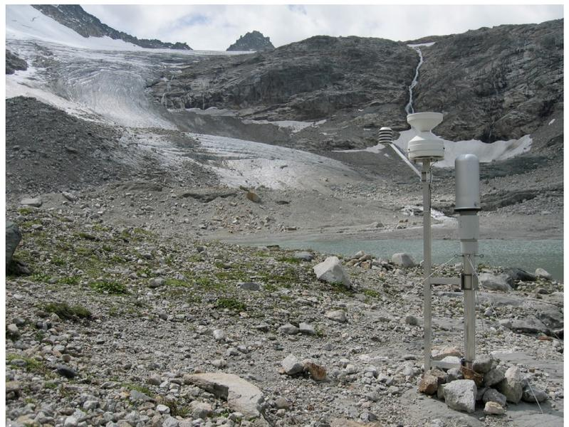
Fernübertragene Abflussmessung mit Niederschlags- und Lufttemperaturmessung am vergletscherten nur 2,7 km<sup>2</sup> großen Einzugsgebiet des Goldbergbaches unter dem Hohen Sonnblick; Foto: Koboltschnig
