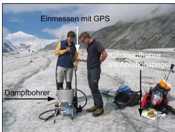
Abb. 4.18: Einbohren eines Ablationsspegels mit dem © Heucke Ice Drill (Heucke, 1999)
