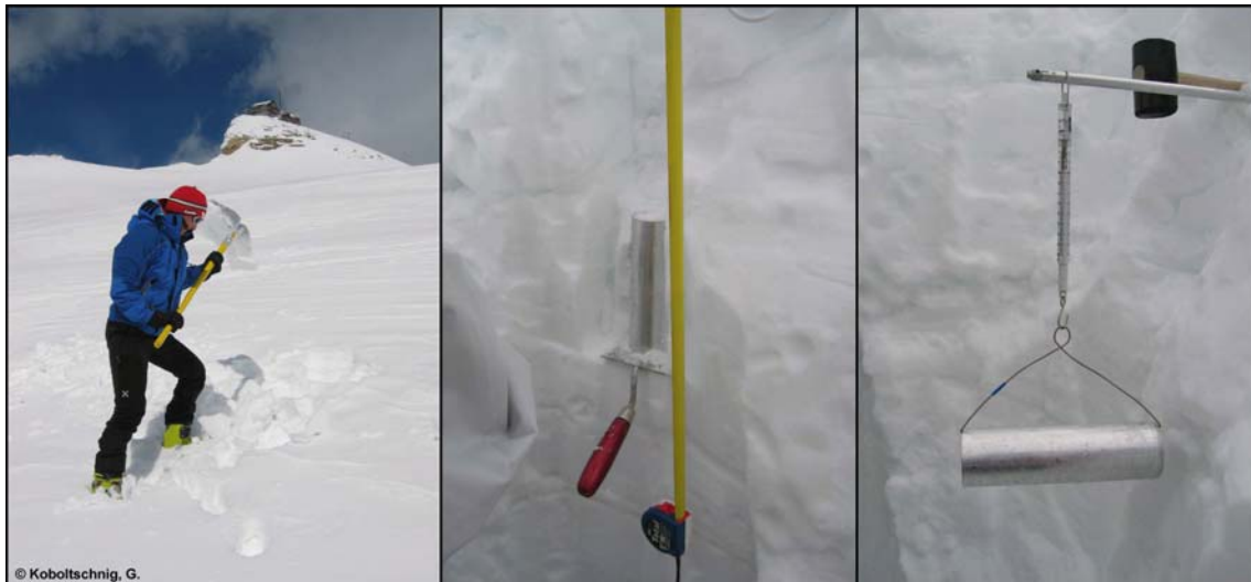
Abb. 4.15: Graben des Schneeschachtes, Messung der Schneedichte durch Ausstechen mit dem Alu-Zylinder (alle 20 cm) und Abwiegen der Probe.
