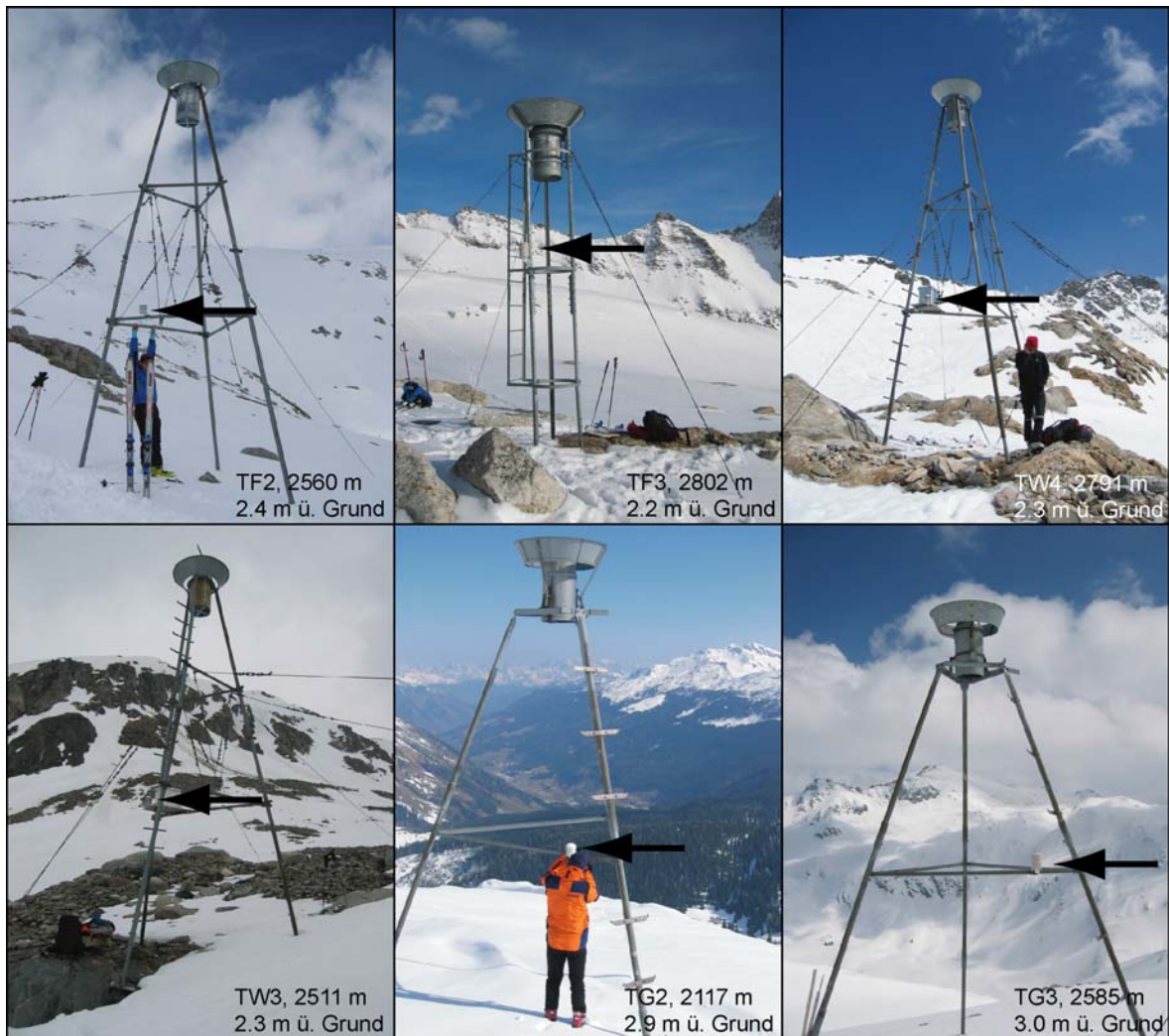
Abb. 4.6: Auf den Totalisatoren angebrachte Lufttemperaturstationen
